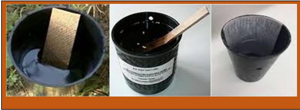
Gambar 7.1: Jenis-jenis ovitrap yang berisi potongan papan kayu (kiri), paddle kayu (tengah), dan kertas saring (kanan). Sumber: International Atomic Energy Agency (IAEA)(2020) .
